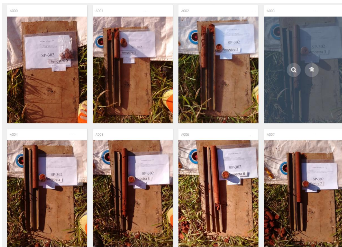
Figura 4. Ilustração do registro fotográfico das amostras e dos amostradores a cada metro ensaiado.
